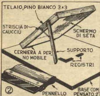
La seta verrà prima fissata al telaio — superficie inferiore — fermandola provvisoriamente con puntine da disegno, senza tenderla troppo, quindi sarà tesa e immobilizzata introducendo nella scanalatura stecche di legno duro di dimensioni eguali alla scanalatura stessa (v. fig. 1).
